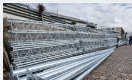
► Postes para luminaria y tramos para torres de telecomunicaciones.
