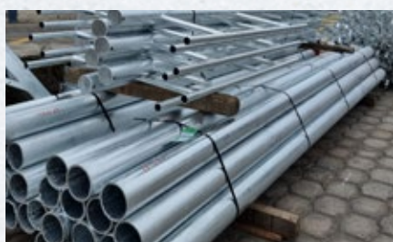
► Tuberías para semaforización.
